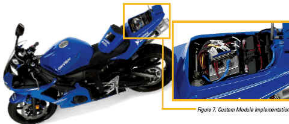
圖 1.7 客製模組用於 Yamaha YZF-R6 之控制火星塞與燃料噴射器[15]
