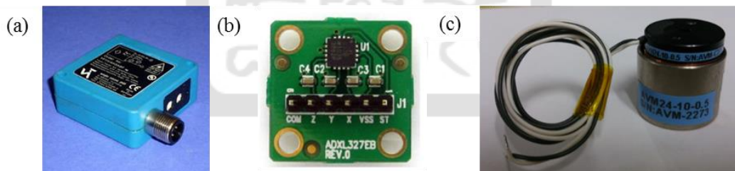
圖 3.14 實驗設備圖 (a) 雷射位移感測器 (b)微機電加速規 (c)音圈致動器
