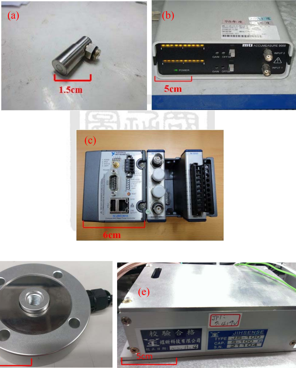
圖 4.6 實驗設備(a)電容式位移感測器(b) 電容式位移訊號放大器 (c) 嵌入式及時控制器(d) 力規(e) 力規訊號放大器
